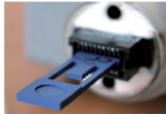
Abb. 1 DSC-Chip gebaut vollständig in LTCC-Technik
