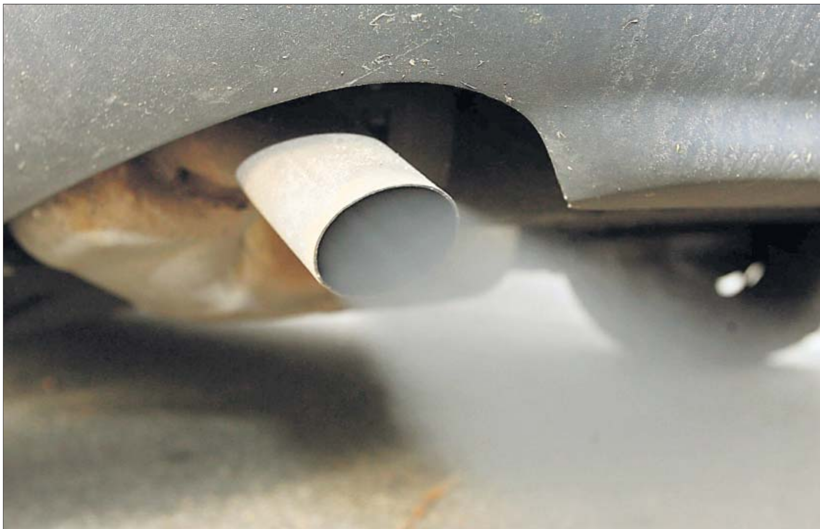
Nur mit Partikelfiltern sind Dieselmotoren umweltfreundlich: Die wenigsten Autobesitzer wissen jedoch, dass der Ruß immer wieder mit der Zugabe von Extrasprit nachverbrannt wird.
